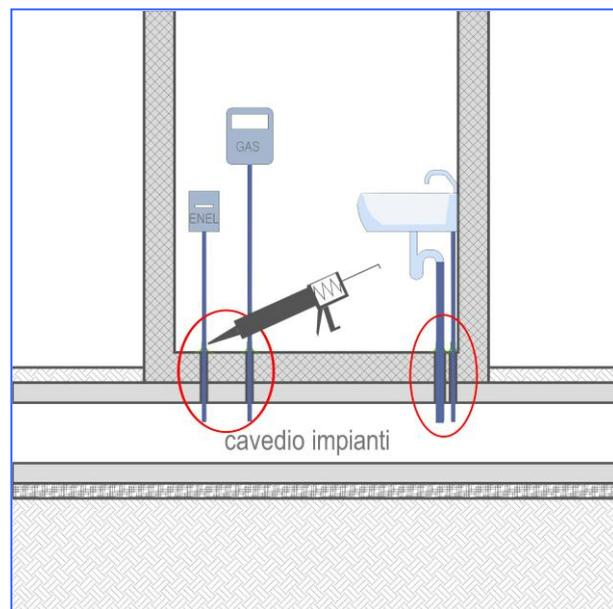
Tutti questi passaggi, che costituiscono una frattura nell'attacco a terra dell'edificio e collegano il terreno con l'interno, dovrebbero quindi essere attentamente sigillati in caso di nuova edificazione ma anche e soprattutto in interventi di bonifica.
