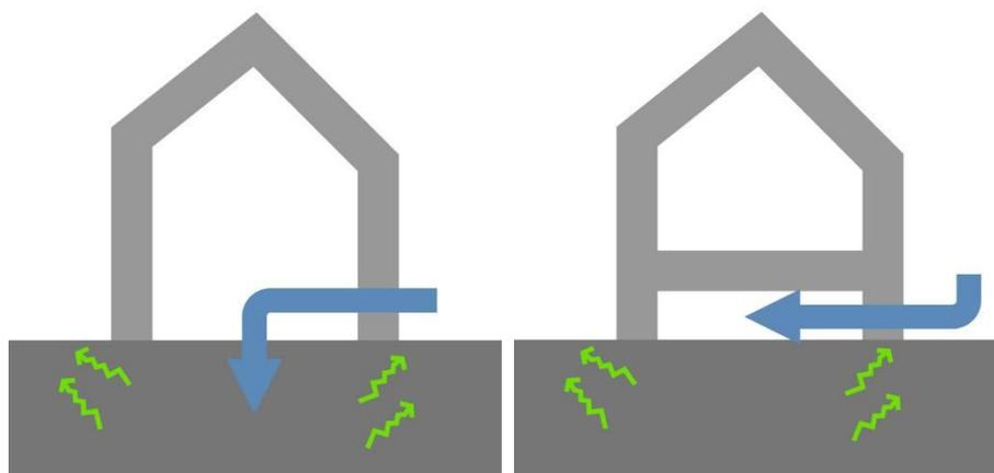
Figura 16: pressurizzazione del terreno o del vespaio
