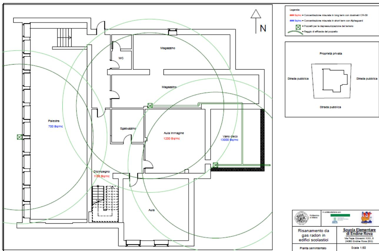
Figura 58: posizione degli estrattori nell'edificio 1
