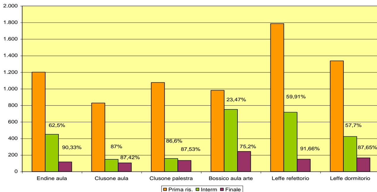
Nella Tabella 6 sono riportati i risultati delle misure long – term eseguite prima e dopo i risanamenti nei locali degli edifici bonificati da cui emerge che sia ha una riduzione dal 44% e il 91% delle concentrazioni di gas radon in relazione alla situazione iniziale.
