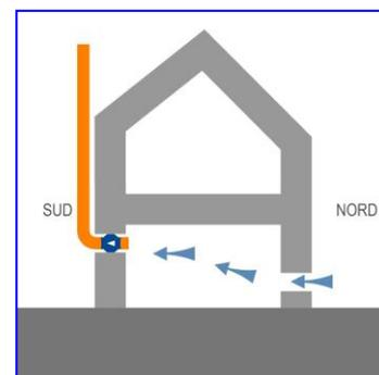
Mentre in caso di ventilazione naturale è indispensabile mantenere aperte una doppia serie di bucaure contrapposte: di ingresso e di uscita dell'aria, per ventilare il volume del vespaio, in caso di ventilazione forzata il più delle volte risulta più conveniente chiudere i fori di ingresso dell'aria per realizzare una maggiore depressione/pressione, nei confronti del terreno. Soprattutto in caso di pressurizzazione.
