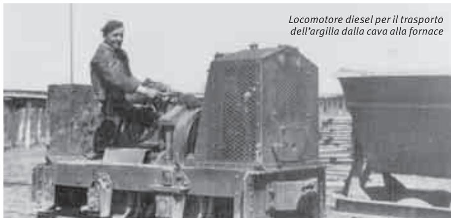
*Locomotore diesel per il trasporto dell'argilla dalla cava alla fornace*
