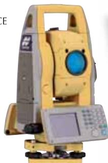
Tramite una piccola scheda CF è possibile integrare GPS e Stazione Totale.
