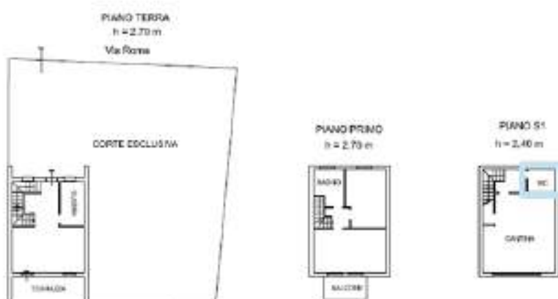
Esempio di locale accessorio a servizio diretto di locali indiretti comunicanti (poligono tipo B)
