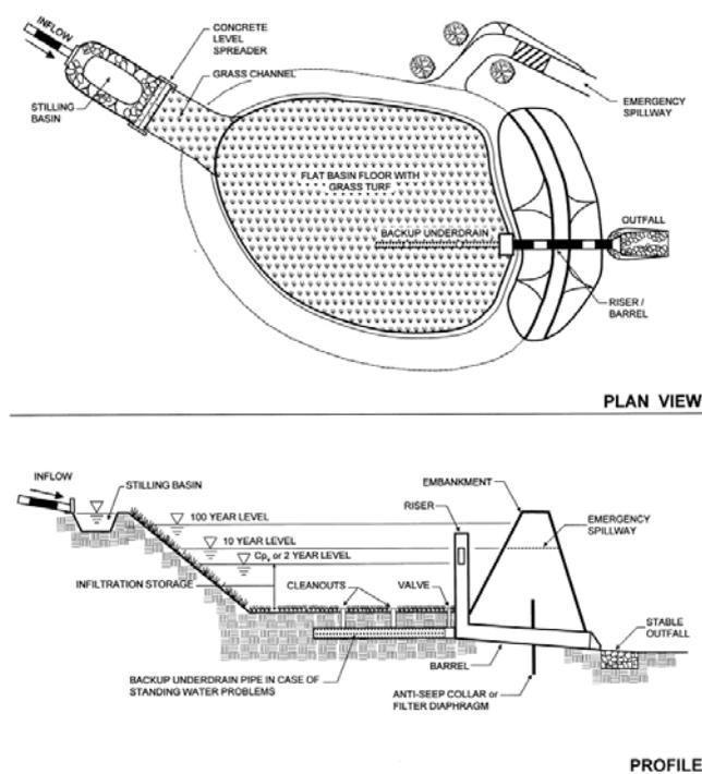
La profondità del bacino viene calcolata tenendo conto di un tempo massimo di ritenzione dell'acqua nel bacino stesso, usualmente posto inferiore alle 48 ore.
