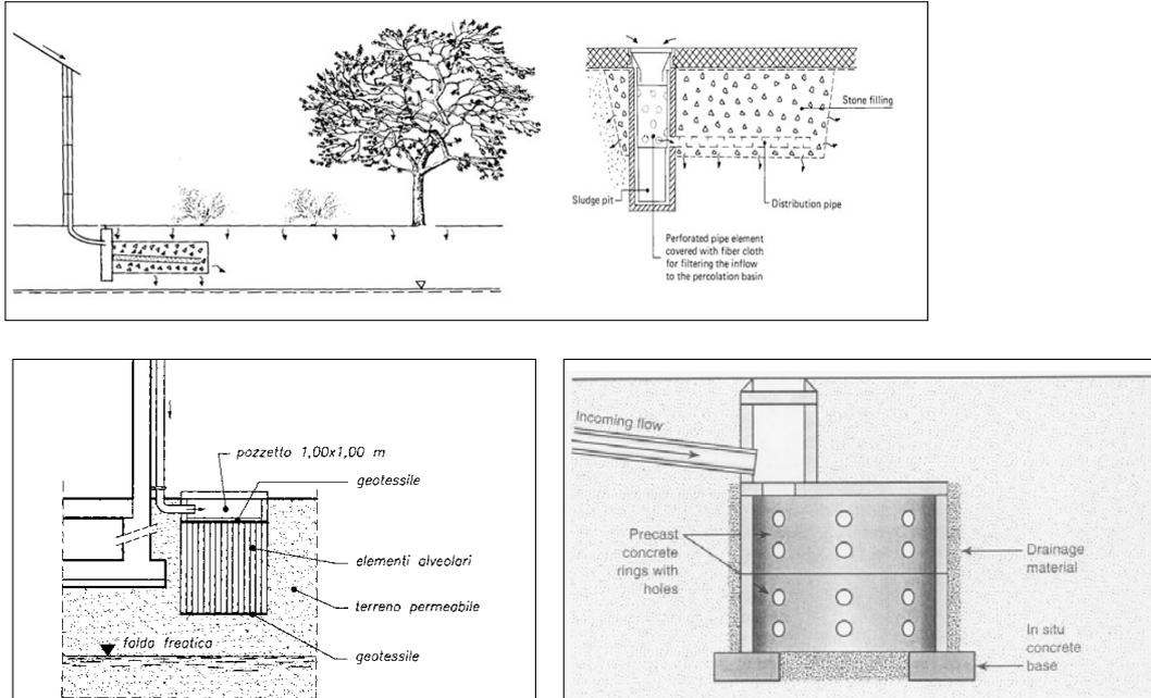
Anche per i pozzi d’infiltrazione può essere necessario prevedere l’inserimento di pre-trattamenti per l’intercettazione di sedimenti ed oli che possono ostruire la struttura. È opportuno inserire nelle grondaie dei filtri al fine di intrappolare particelle, foglie ed altri detriti.
