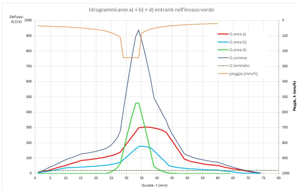
Risulta che l'idrogramma complessivo  $Q_e(t)$  presenta una portata al colmo pari a 940 l/s circa (quindi assolutamente inaccettabile rispetto alla portata limite complessiva ammissibile di 16,25 l/s).
