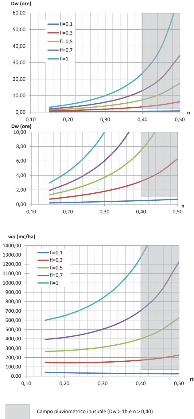
Figura 7 - Grafici della durata  $D_w$  (eq. 12») e del volume specifico critico di invaso  $w_o$  (eq. 13») in funzione di  $n$ , per  $\alpha=80$  mm/ora e per  $u = 10$  l/s per ettaro
