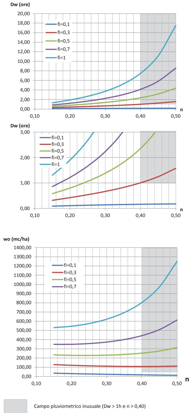
Figura 11 - Grafici della durata  $D_w$  (eq. 12») e del volume specifico critico di invaso  $w_o$  (eq. 13») in funzione di  $n$ , per  $\alpha=80$  mm/ora e per  $u = 20$  l/s per ettaro
