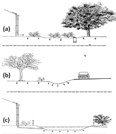
Figura 28 – Esempi di trincee d’infiltrazione
