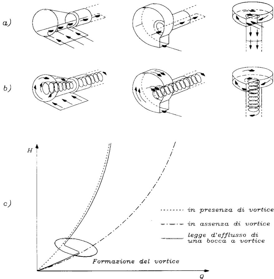
Essi vengono chiamati anche hydrobrake o vortex amplifier nella terminologia anglosassone. Possono essere a due o a tre vie. Il moto vorticoso riduce sensibilmente il coefficiente d'efflusso a valori prossimi a  $(0.2 \div 0.3)$ . La loro installazione consente di mantenere le luci di efflusso più ampie, quindi meno intasabili, e di garantire l'autopulizia dello scarico per effetto del vortice.
