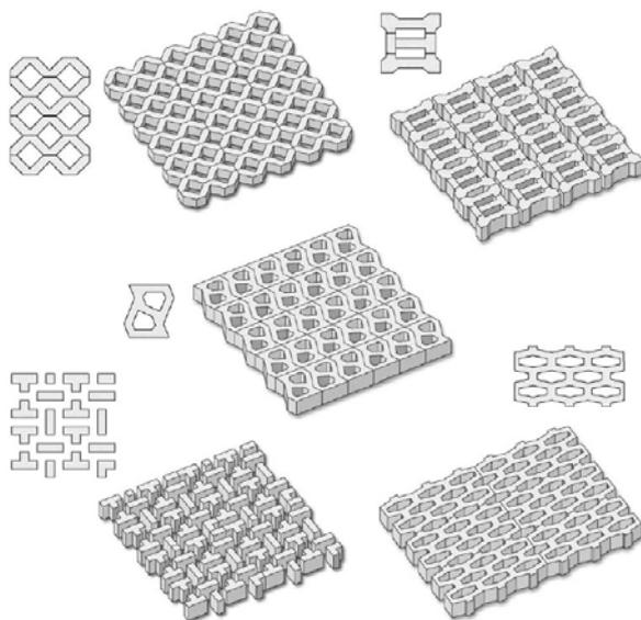
**Figura 34 - Esempi di pavimentazioni permeabili**
