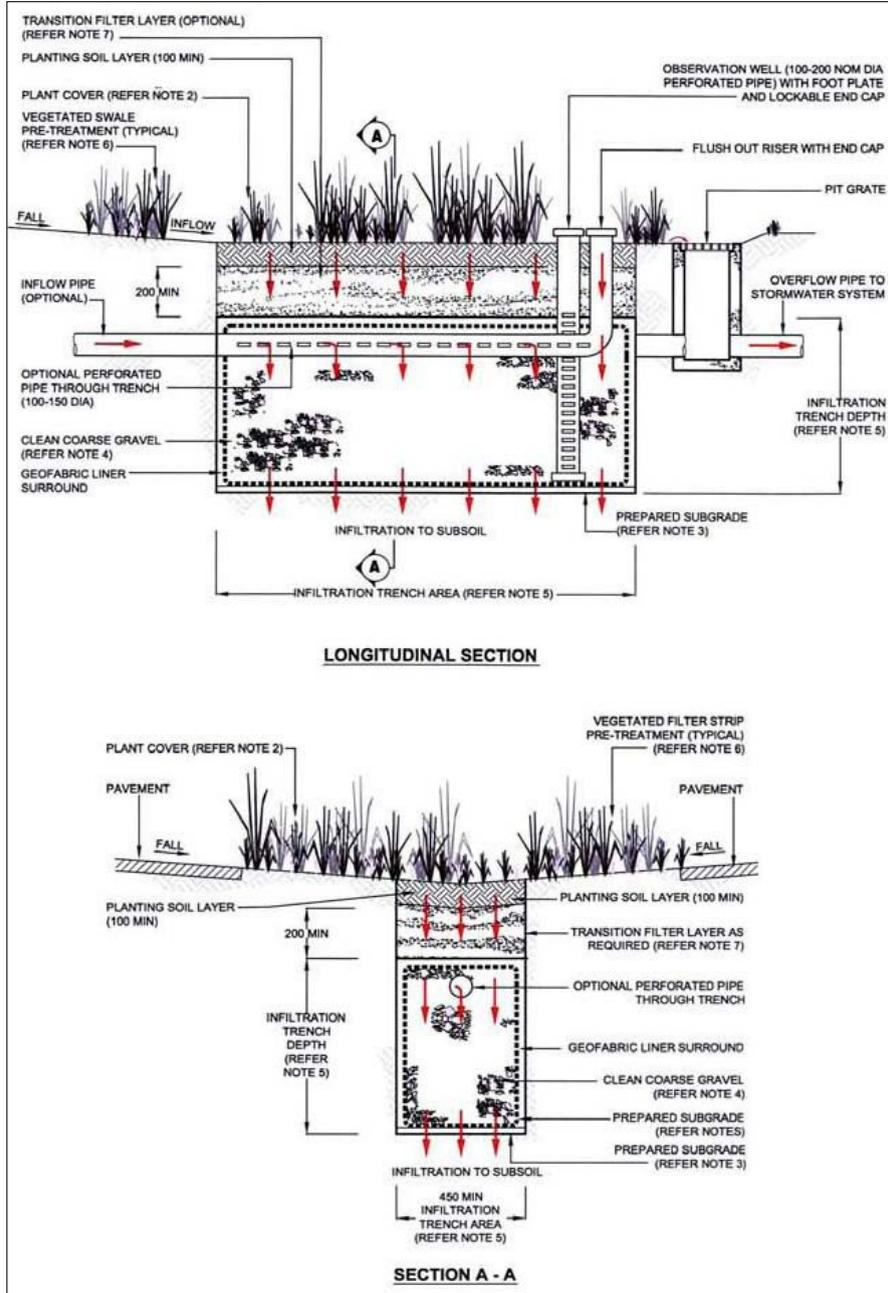
Figura 27 - Opere di infiltrazione [da: Urbonas e Stahre, 1993]
