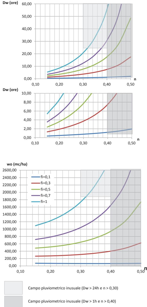
Figura 9 - Grafici della durata  $D_w$  (eq. 12») e del volume specifico critico di invaso  $w_o$  (eq. 13») in funzione di  $n$ , per  $\alpha=40$  mm/ora e per  $u = 20$  l/s per ettaro
