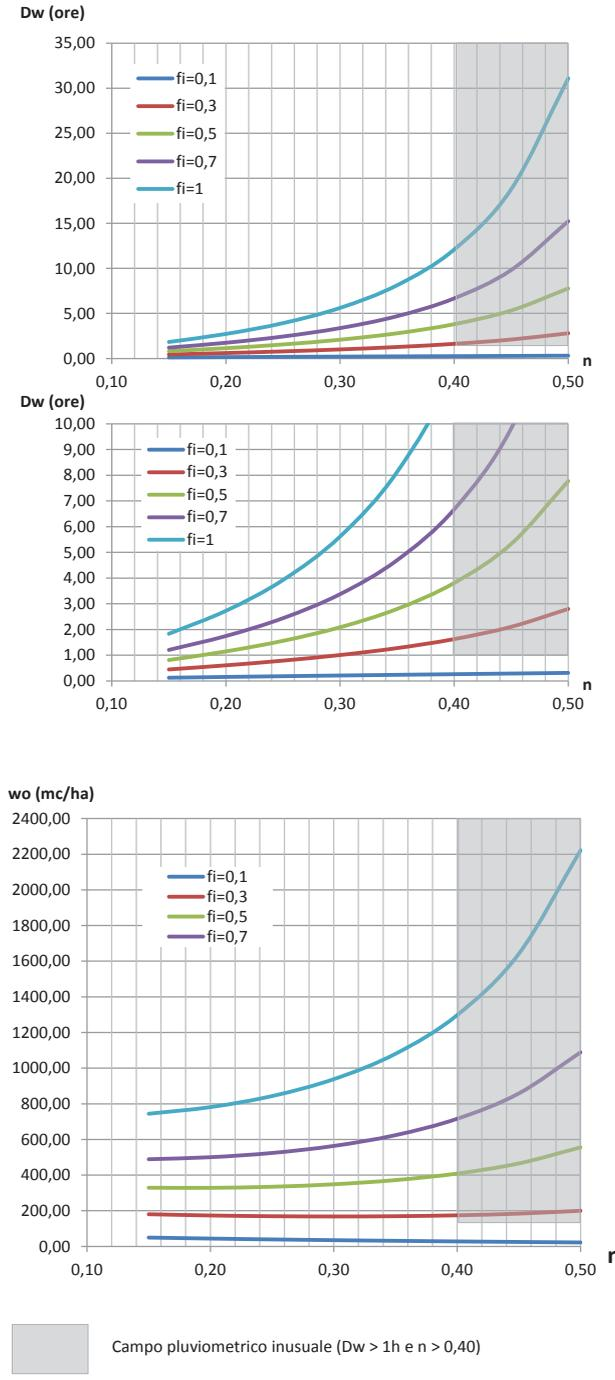
Figura 12 – Grafici della durata  $D_w$  (eq. 12») e del volume specifico critico di invaso  $w_o$  (eq. 13») in funzione di  $n$ , per  $\alpha=100$  mm/ora e per  $u = 20$  l/s per ettaro
