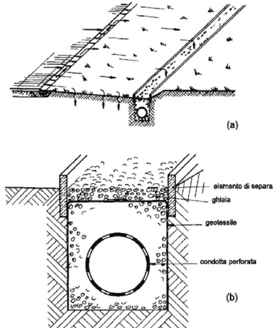
Le trincee possono essere allocate in superficie o nel sottosuolo: quelle in superficie ricevono il deflusso superficiale direttamente dalle aree adiacenti mentre quelle nel sottosuolo possono ricevere il deflusso da altre reti drenanti, ma richiedono l'utilizzo di ulteriori pre-trattamenti per impedire che particolato grossolano, terreno e foglie occludano la struttura.
