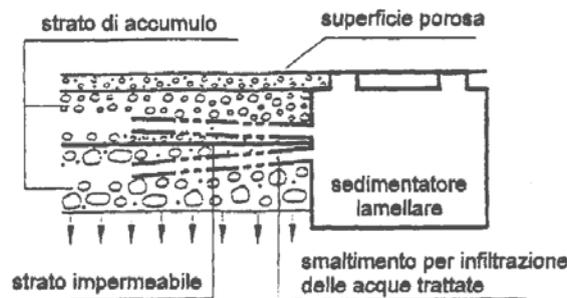
Indagini su campo eseguite in Florida hanno evidenziato che le pavimentazioni filtranti utilizzate nelle aree di parcheggio, se correttamente installate e controllate, continuano ad infiltrare le acque piovane anche dopo 15 anni.
