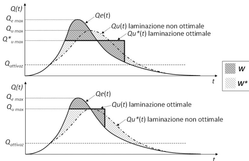
Questo schema di regolazione teorica è raggiungibile in modo approssimato quando l'uscita è governata da un impianto di sollevamento avente portata  $Q_{u,max}$  o con opportuni automatismi di regolazione degli scarichi, come i regolatori di portata che modificano la luce d'effluo in funzione del battente in modo da mantenere costante la portata uscente  $Q_{u,max}$ .
